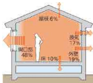
図27 冬の暖房時に外に熱が逃げる割合の例 H4年省エネ基準レベルの家全体での計算例(住宅省エネルギー技術施工技術者講習テキスト、p25)
