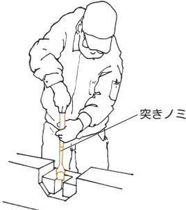
▲【図27】突きノミを使って加工した部分を正確に仕上げる
