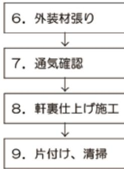
①発煙タイプ防虫剤などにより、基礎側から煙を入れてみて、壁上に抜けていることを確認する。
